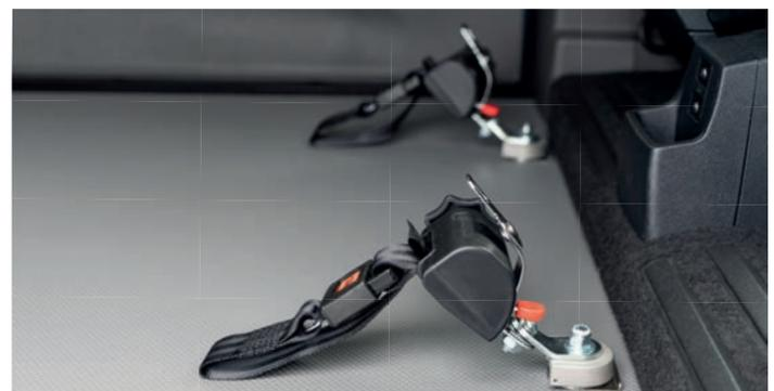
Die Personensicherung erfolgt über den zusätzlich eingebauten Schulterschräggurt und einem passenden Beckengurt. Zur vorschriftsmäßigen und vor allem sicheren Beförderung einer im Rollstuhl sitzenden Person sind diese Sicherungsgurte zwingend erforderlich.
